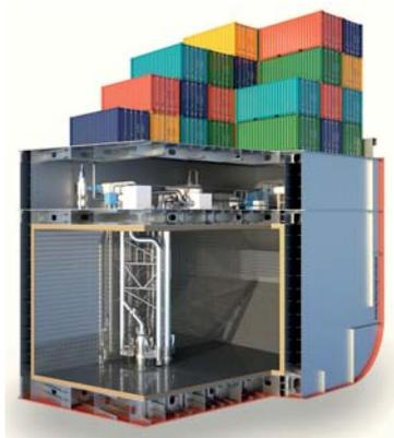
Exemple d'une conversion d'un porte conteneurs caboteur de grande taille par jumboisation et insertion d'une section de navire contenant la cuve de combustible GNL et le local de préparation de gaz.
